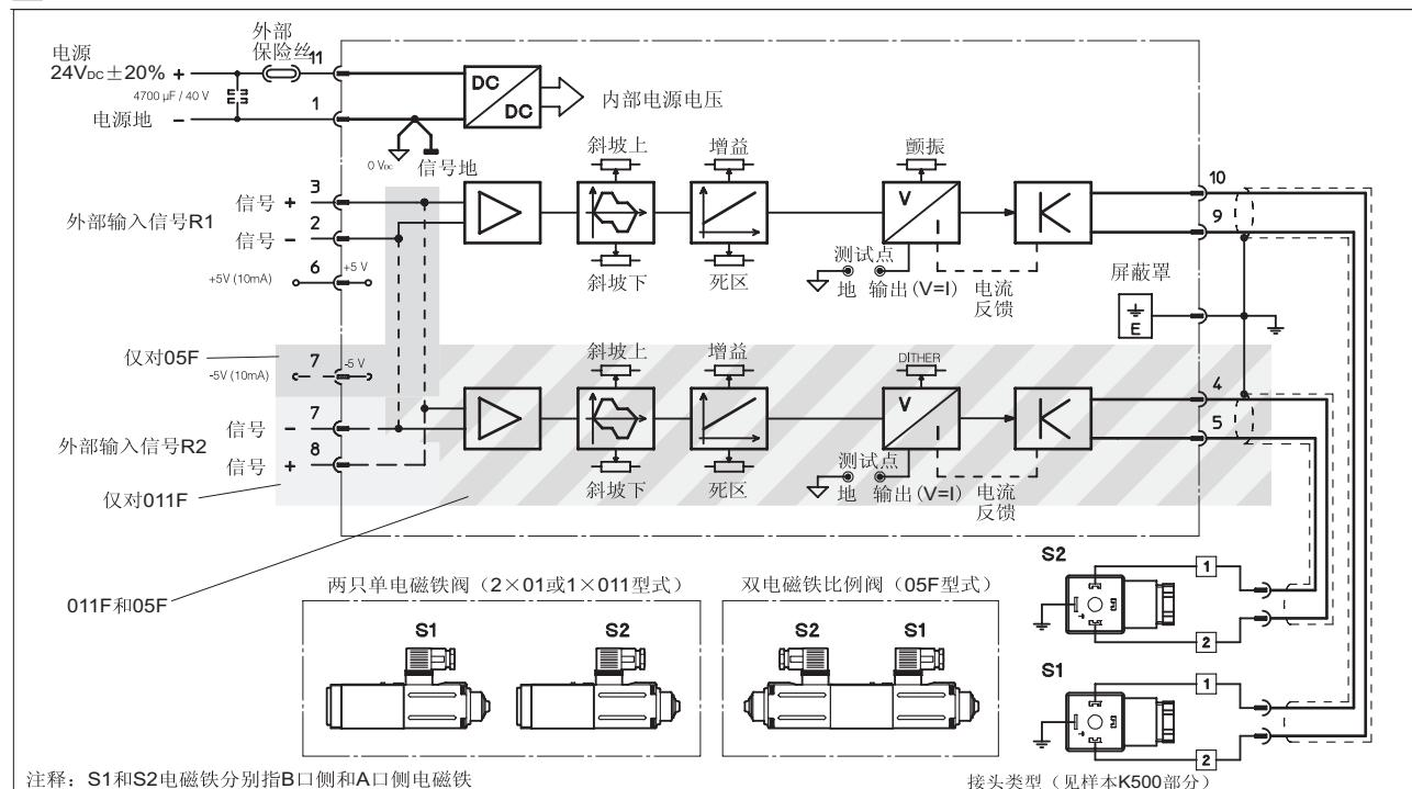
注释：S1和S2电磁铁分别指B口侧和A口侧电磁铁
