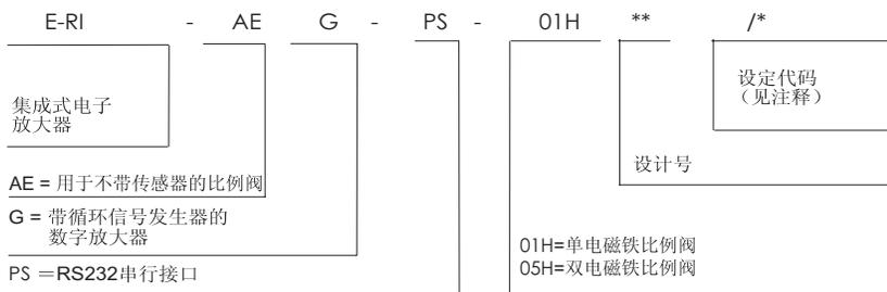
注释：设定代码表明数字放大器与所匹配的比例阀间的对应关系。当放大器作为备件单独订货时，由Atos出厂设定。
