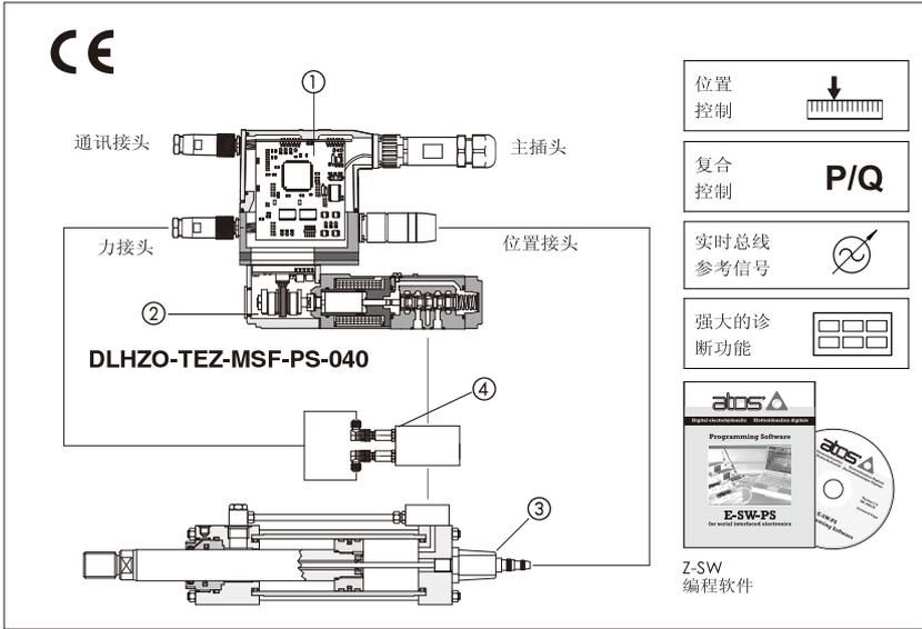
Z-RI型集成式数字控制器①，除了基本的可作为比例阀的放大器功能外，还可与比例阀相连，形成对直线型或旋转型执行器的位置闭环控制。
