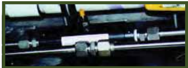
这个直螺纹连接的消声器，很容易安装到正在工作的管路中，在这里有两个管道，一个很容易代替另一个。
