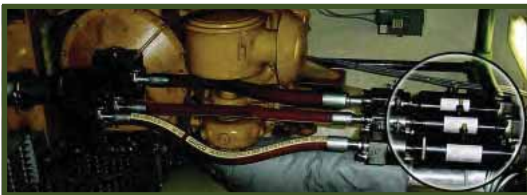
关于这个装置最初的想法是在消声器前面加上软管，可以减少噪音和冲击。
